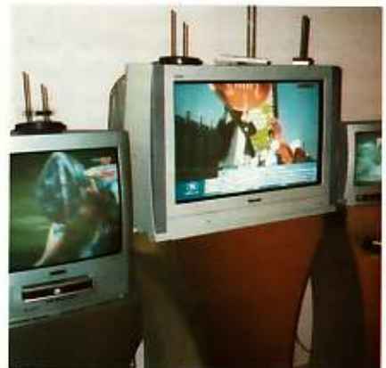
Twee verschillende antenntypes. Rechts de actieve van Funke.
